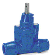
Sarja 03/30 Talosulkuventtiili vetoakestävillä pistopäillä PE putkille PN16 SG valurauta DN20-50
