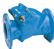
Sarja 41/60 Lämpätakaiskuventtiili vapaa akselin pää Joustotiivisteinen SG-valurauta DN 50-300
