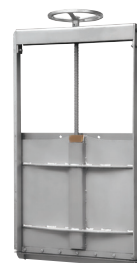
Sarja 772/61 Seinään asennettava sulkuluukku Kaksisuuntainen kokoon 1200 X 1200 mm asti, suuremmat koot yksi- tai kaksisuuntaisia Nousematon kara Ruostumaton teräs AISI 304 200x200 mm - 2000x2000 mm
