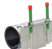
Sarja 748 Korjausmuhi Yksiosainen tai kaksiosainen AISI304 tai AISI316 EPDM tai NBR
