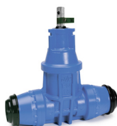
Sarja 16/54 Talosulkuventtiili vetoakestävillä pistopäillä PE putkille Haponkestävä AISI316 kara NBR kumiluisti PN16 POM (Polyoxymethylene) DN25-50
