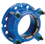
Sarja 623 Supa Plus™ laippaliitin Vetoakestävä PE and uPVC putkille SG-valurauta DN 40-300
