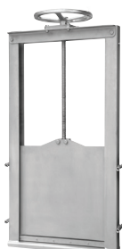
Sarja 772/7172 Kanavaluukku Yksisuuntainen kokoon 1000 X 1000 mm asti, suuremmat koot kaksisuuntaisia Nousematon kara Ruostumaton teräs AISI 304 200x200 mm -2000x2000 mm
