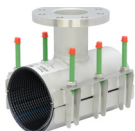
Sarja 729/32 Korjausmuhi laippahaaralla Kaksiosainen AISI304 tai AISI316 EPDM tai NBR
